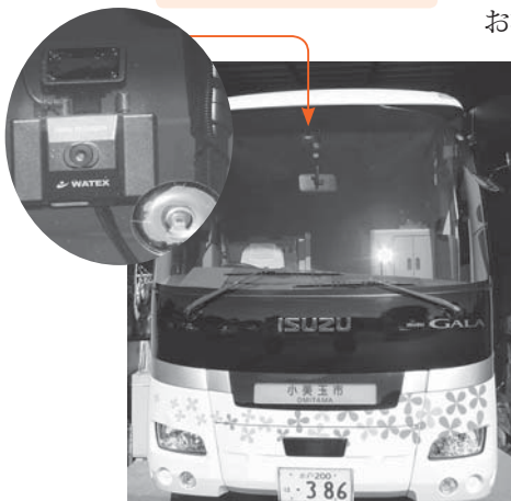
交通事故前後の映像と音声を記録できるドライブレコーダー
