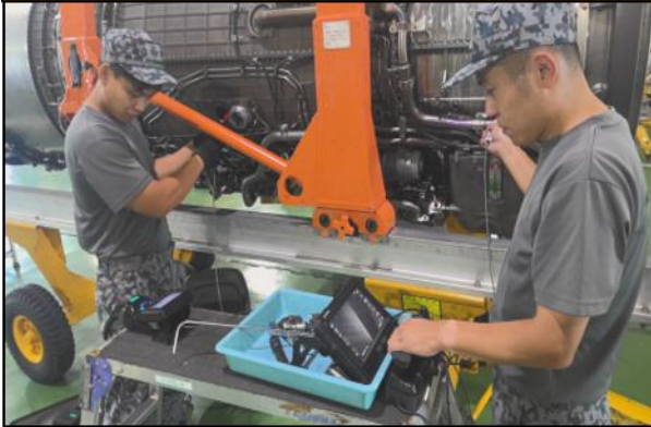
内視鏡カメラを用いた エンジン内部の点検
