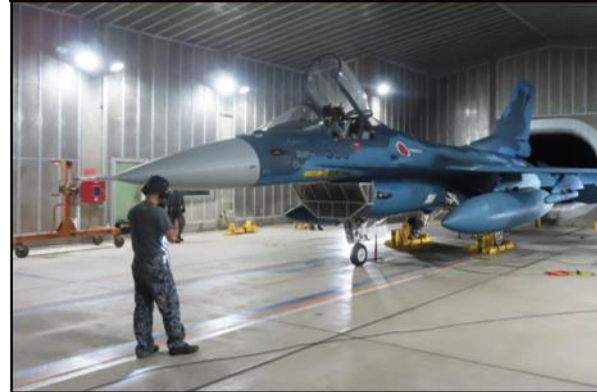
エンジン出力及び 出力信号の点検
